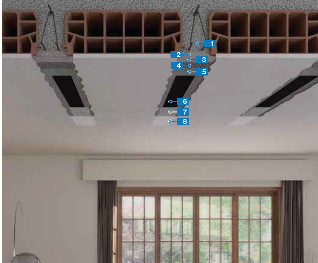
Kerámia béléstartes vasbeton gerenda megerősítése hajlításra
